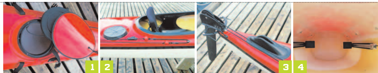
1. Stilrent og flushdekket lukeløkk med gummi innerdel. 2. H2O kan leveres med forskjellige seteløsninger med og uten demonterbar ryggstø. Legg merke til hullet i skrogsidene - her er mulighet for selvredning ved hjelp av pontonger. 3. Rorarrangementet fungerer som det skal. 4. H2O kan leveres med langsgående skinner med styrepedaler som her, eller med styrpinne.
