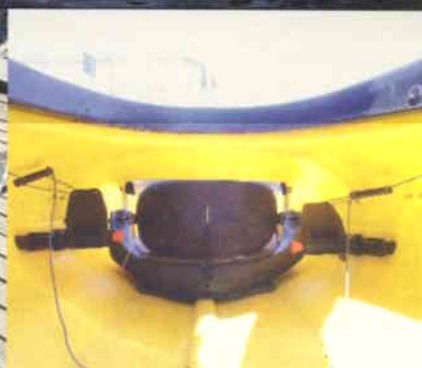
Pedaljusteringen gjøres enkelt ved å trekke ut de røde knottene og skyve pedalene innover eller utover langs skinnene.
