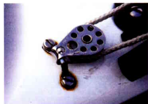
Flot bøyle som att på til rustet på undersiden.
