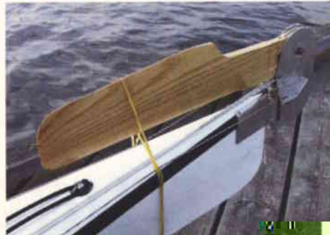
Solid roroppheng med aquadynamisk rorblad av tre
