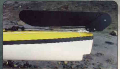
Roret er av aluminium. Nedslått gir det etter ved eventuell kontakt med bunnen.
